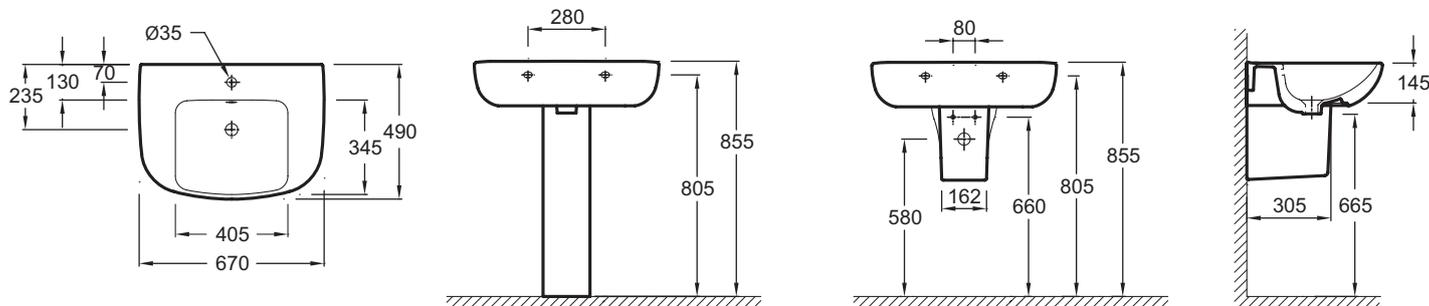
Спецификация продукта: Раковина 67 x 49 см с заглушкой. E4754C. Коллекция: ODEON UP. Размеры (см): 67 x 49 см. Вес: 19,6 кг. Разметка сверления отверстия для смесителя: 1 отверстие для смесителя, 2 дополнительных отверстия. Рекомендуемые смесители: Aleo, стильный и широкий ассортимент.
