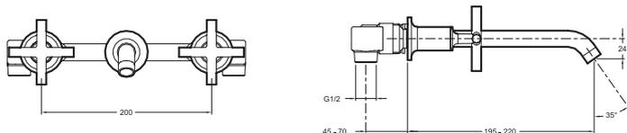
Descriptif CCTP : Mélangeur lavabo mural 3 trous, bec fixe. E144153. Collection : PURIST. POIDS : 2,8 kg. TYPE D'INSTALLATION : Mural. NORMES ET RÉGLEMENTATIONS : ACS : 15 ACC LY 081. DÉBIT (L/MN SOUS 3 BARS) : 10 l/mn. MÉCANISME : Têtes à disques céramique. ENTRAXE (MM) : 102. VIDAGE : Sans vidage. TYPE D'INSTALLATION : 3 trous. GARANTIE MÉCANISME : 5 ans. Bec fixe. Corps à encastrer. Aérateur anti-calcaire. Sans bonde de vidage. Poignées "Croix".
