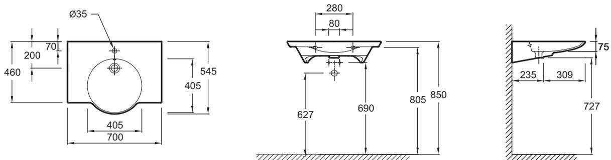
Descriptif CCTP : Plan-vasque 70 cm. E4492. Collection : SPHERIK. DIMENSIONS : 70 x 54,50 cm. POIDS : 21 kg. MATÉRIAU : Céramique. TYPE D'INSTALLATION : Autoportant. PERCEMENT ET PRÉ-PERCEMENT ROBINETTERIE : Percé 1 trou au centre. FIXATIONS : Par 2 goujons non fourni. PERCEMENT ROBINETTERIE : Percé 1 trou pour robinetterie. TROP-PLEIN : Avec trou de trop plein. NOMBRE DE VASQUES : Simple vasque. PRODUIT INCLUS : (robinetterie non incluse). ROBINETTERIE CONSEILLÉE : Stillness E979-4.
