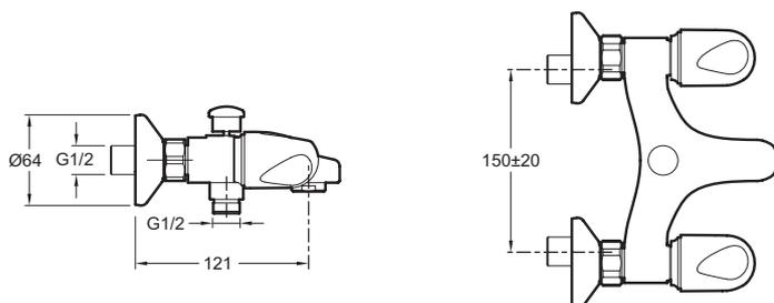
Спецификация продукта: Настенный смеситель для ванны/душа. E71920. Коллекция: GALEO CD. ВЕС: 1,4 кг. ТИП УСТАНОВКИ: Крепление к стене. ТИП: Двурывчажный. РАСХОД ВОДЫ: 20/13 л/мин при давлении 3 бар. ПОДКЛЮЧЕНИЕ: С настенными крепежами и кольцами. МЕХАНИЗМ: Кран-буксы с керамическим диском. РАЗМЕТКА ОТВЕРСТИЙ: 150 ± 20 мм. СЛИВ: 0. ОДНОРЫЧАЖНЫЙ СМЕСИТЕЛЬ: 0. УСТАНОВКА: Настенные. ГАРАНТИЯ НА ОТДЕЛКУ: 0. Металлические ручки. Автоматический переключатель. Обратный клапан на выходе для душа.
