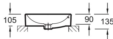
Descriptif CCTP : Vasque à poser 40 cm, avec trop-plein. EVG102. Collection : VOX. DIMENSIONS : 40 x 40 cm. POIDS : 10,6 kg. MATÉRIAU : Céramique. TYPE D'INSTALLATION : Posé. PERCEMENT ROBINETTERIE : Sans trou de robinetterie. CONFIGURATION : STANDARD. MEULÉ/NON-MEULÉ : Meulé, pour une installation parfaite avec un meuble ou un plan de travail. TROP-PLEIN : Avec trou de trop-plein. ROBINETTERIE CONSEILLÉE : Composed.
