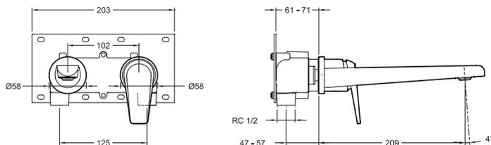
Descriptif CCTP : Mitigeur lavabo mural avec corps à encastrer. E97358. Collection : AVID. POIDS : 3,8 kg. TYPE D'INSTALLATION : Mural. NORMES ET RÉGLEMENTATIONS : ACS : 14 ACC LY 511. DÉBIT (L/MN SOUS 3 BARS) : 5 l/mn. SAILLIE DU BEC (MM) : 209. RACCORDS : Corps à encastrer (G1/2). MÉCANISME : Cartouche à disques céramique. TYPE D'INSTALLATION : 2 trous. GARANTIE MÉCANISME : 5 ans. Sans bonde de vidage.
