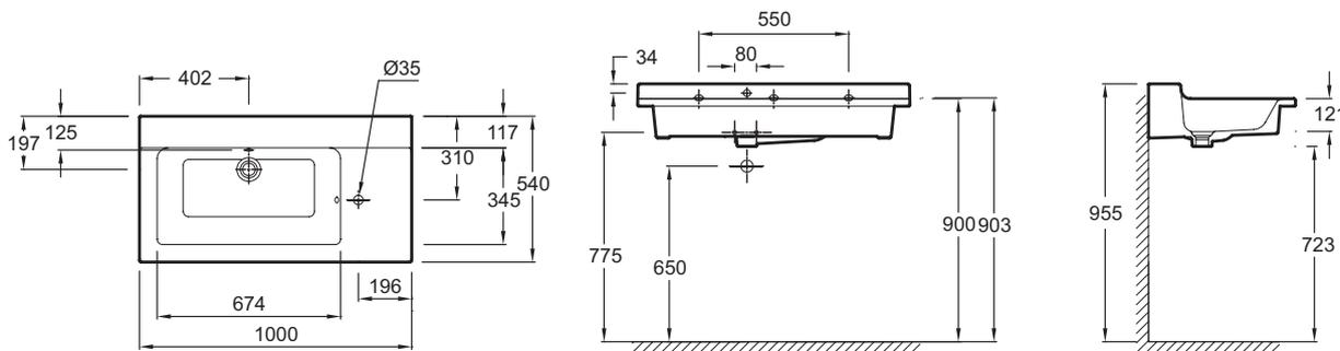
Спецификация продукта: Подвесная раковина-столешница 100 x 54 см. EXK122. Коллекция: SOPRANO. Размеры (см): 100 x 54 см. Вес: 32 кг. Разметка сверления отверстия для смесителя: С 1 отверстием для встроенного смесителя E99399. Дополнительная опция: Опорные ножки и полотенцесушитель.
