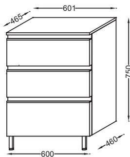
Спецификация продукта: Дополнительный модуль 60 см, 3 выдвижных ящика. EB2065-RA. Коллекция: VOX. РАЗМЕРЫ (СМ): 60 x 46 x 75 см. ВЕС: 36 кг. МАТЕРИАЛ: Лак или меламин или декор под дерево. МЕСТО ДЛЯ ХРАНЕНИЯ: 3 выдвижных ящика с механизмом «плавное закрывание». РЕШЕНИЕ ХРАНЕНИЯ: Выдвижные ящики. ДОПОЛНИТЕЛЬНЫЙ МОДУЛЬ: Тумбы. РУЧКИ: Встроенная ручка из нержавеющей стали.
