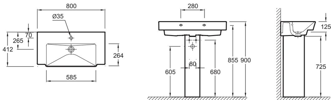
Спецификация продукта: Полуистраиваемая раковина-столешница 80 x 41.2 см. E4803. Коллекция: REVE. РАЗМЕРЫ (СМ): 80 x 41,20 см. ВЕС: 25 кг. МАТЕРИАЛ: Керамика. РАЗМЕТКА СВЕРЛЕНИЯ ОТВЕРСТИЯ ДЛЯ СМЕСИТЕЛЯ: С 1 отверстием для смесителя по центру. ОТВЕРСТИЯ ДЛЯ СВЕРЛЕНИЯ: С 1 отверстием для смесителя. УСТАНОВКА: Угловые. ОТВЕРСТИЕ ПЕРЕЛИВА: С отверстием перелива. КОЛИЧЕСТВО РАКОВИН В СТОЛЕШНИЦЕ: Стандартные. ПРОДУКТ В КОМПЛЕКТЕ: (смеситель заказывается отдельно).
