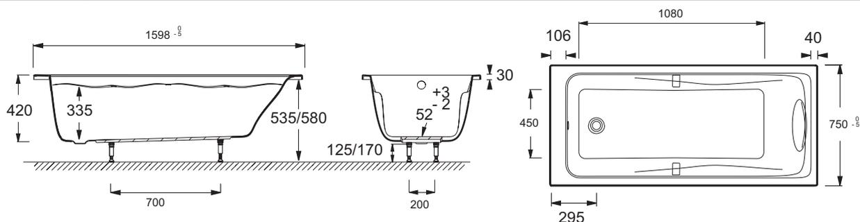
Спецификация продукта: Ванна 160 x 75 см для установки с каркасом. E6057RU. Коллекция: ODEON UP. РАЗМЕРЫ (СМ): 160 x 75 x 42 см. ВЕС: 16 кг. МАТЕРИАЛ: Акрил. ТИП УСТАНОВКИ: Встраиваемые. ОБЪЕМ: 190/120. ФОРМА: Прямоугольные. ВЫСОТА НОЖЕК: 115/155. ДИАМЕТР СЛИВА: 5.2 см. НОЖКИ: Не в комплекте. СТУПЕНЬКА: Не в комплекте. СЛИВ: Не в комплекте. Дополнительная опция: Автоматический слив-перелив (1м) E70174, экран на прямоугольную ванну E4932.
