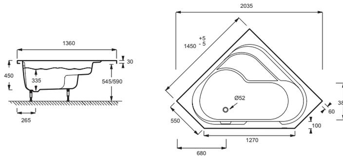
Спецификация продукта: Угловая левосторонняя ванна-душ. E6222. Коллекция: BAIN-DOUCHE. РАЗМЕРЫ (СМ): 145 x 145 x 45 см. ВЕС: 26 кг. МАТЕРИАЛ: Акрил. ТИП УСТАНОВКИ: Угловые. ОБЪЕМ: 270/200. ФОРМА: Угловые. ВЫСОТА НОЖЕК: 95/140. ДИАМЕТР СЛИВА: 5.2 см. ДОПОЛНИТЕЛЬНАЯ ИНФОРМАЦИЯ: Угловая. МОДЕЛЬ: Левосторонняя. НОЖКИ: В комплекте. СТУПЕНЬКА: Не в комплекте. СЛИВ: Не в комплекте.
