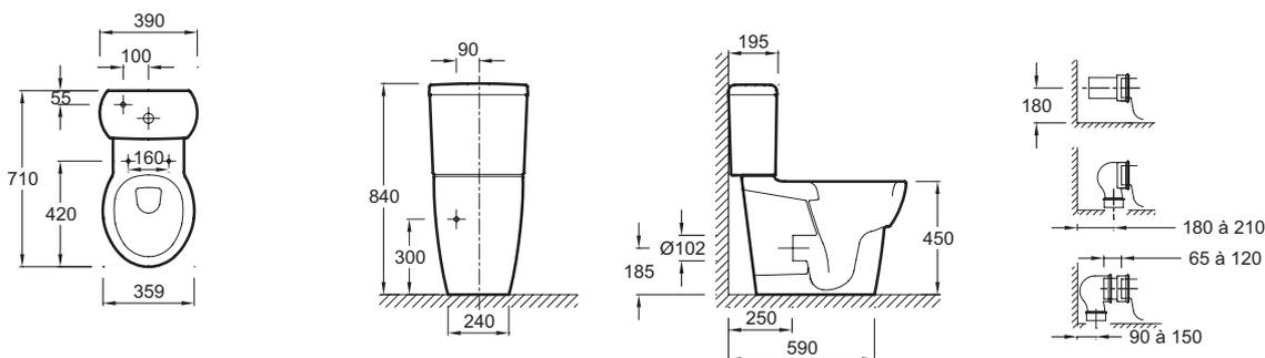
Спецификация продукта: Высокий унитаз «vario». 19967W. Коллекция: OVE. РАЗМЕРЫ (СМ): 71 x 35,90 см. ВЕС: 27 кг. МАТЕРИАЛ: Керамика. РАСХОД ВОДЫ: Стандарт: 3/6 л. ВЫСОТА: Высокие/ПРОФ. ОБОД: Увеличенная высота/для людей с ограниченными возможностями. ПРОДУКТ В КОМПЛЕКТЕ: (Бачок не в комплекте). Крышка-сиденье не входит в комплект.
