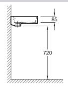
Descriptif CCTP: Lave-mains 45 cm. EGN112. Collection: ODÉON RIVE GAUCHE. DIMENSIONS: 45 x 36 cm. POIDS: 10,4 kg. MATÉRIAU: Céramique. TYPE D'INSTALLATION: Autoportant ou peut être monté sur un meuble spécifique. PERCEMENT ROBINETTERIE: 1 trou. TROP-PLEIN: Avec. NOMBRE DE VASQUES: 1 cuve. ROBINETTERIE CONSEILLÉE: Odéon Rive Gauche. INFOS COMPLÉMENTAIRES: Robinetterie non incluse. NOUVEAUTÉ: 0.
