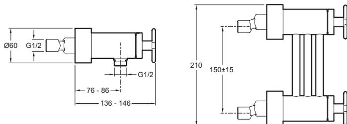
Спецификация продукта: Настенный смеситель для душа. E78344. Коллекция: NOUVELLE VAGUE. ВЕС: 2,9 кг. ТИП УСТАНОВКИ: Крепление к стене. РАСХОД ВОДЫ: 10 л/мин. ПОДКЛЮЧЕНИЕ: С соединителями и настенными крепежами. МЕХАНИЗМ: Кран-букса с керамическим диском. СЛИВ: Без донного клапана. ОДНОРЫЧАЖНЫЙ СМЕСИТЕЛЬ: 0. УСТАНОВКА: 2 отверстия. ГАРАНТИЯ НА ОТДЕЛКУ: 10 лет на покрытие "Матовый хром" и 25 лет на покрытие "Матовый черный".
