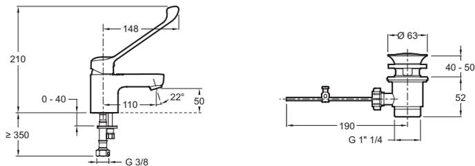
Спецификация продукта: Смеситель для раковины July с донным клапаном. E16024-4. Коллекция: EASY. ВЕС: 1,2 кг. РАСХОД ВОДЫ: 10 л/мин при давлении 3 бар. ВЫСОТА ПОД ИЗЛИВОМ: 210 мм. РАССТОЯНИЕ МЕЖДУ ЦЕНТРОМ ИЗЛИВА И ЦЕНТРАЛЬНОЙ ОСЬЮ КОРПУСА: 110 мм. МЕХАНИЗМ: Последовательный керамический картридж. УСТАНОВКА: 1 отверстие. Установлено коленное соединение (на уровне 150 мм).
