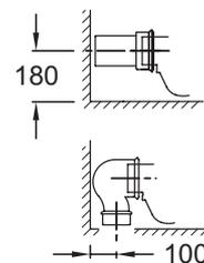
Спецификация продукта: Унитаз «vario» без бачка 54 x 36 см, устанавливаемый вплотную к стене. E4772. Коллекция: VIRAGIO. Размеры (см): 54 x 36 см. Вес: 29 кг. Материал: Керамика. Тип установки: Напольные. Объем воды: Экономия воды: 2.6/4 л. Высота: Комфорт. Тип обода: Открытый обод. В комплекте: крышка-сиденье с механизмом "плавное опускание" из термодюра 6472K, на металлических шарнирах. Водосберегающий 2.6/4л двойной смыв или 3/6л стандартный смыв.
