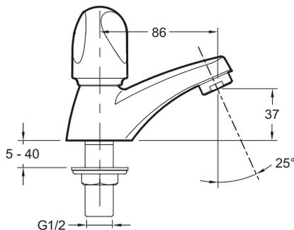
Спецификация продукта: Кран с ручкой для холодной воды. E72922. Коллекция: GALEO CD. ВЕС: 0,5 кг. РАСХОД ВОДЫ: 10 л/мин при давлении 3 бар. РАССТОЯНИЕ МЕЖДУ ЦЕНТРОМ ИЗЛИВА И ЦЕНТРАЛЬНОЙ ОСЬЮ КОРПУСА: 86 мм. МЕХАНИЗМ: Кран-букса с керамическим диском. СЛИВ: Без донного клапана. УСТАНОВКА: 1 отверстие. Металлическая ручка для холодной воды. Без донного клапана.
