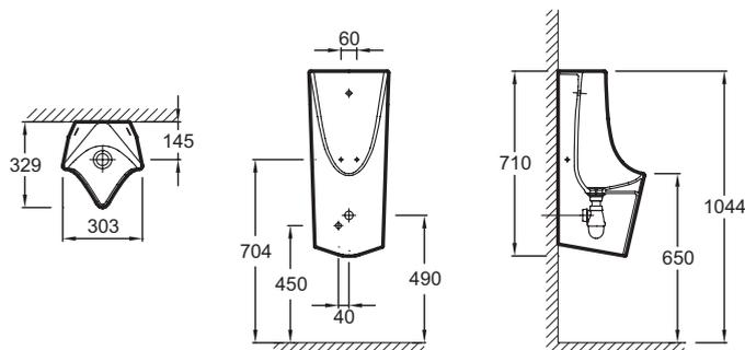
Спецификация продукта: Писсуар 33 x 71 x 30 см, со встроенной сливной трубой и подводкой. EZA022. Коллекция: СТРУКТУРА. РАЗМЕРЫ (СМ): 32,90 x 30,30 см. МАТЕРИАЛ: Керамика. ПОДВОДКА: Подводка. Встроенная подводка и сливная труба, полный комплект аксессуаров (крепежные скобы, распылитель воды, шланг, слив с фильтром и полипропиленовый сифон).
